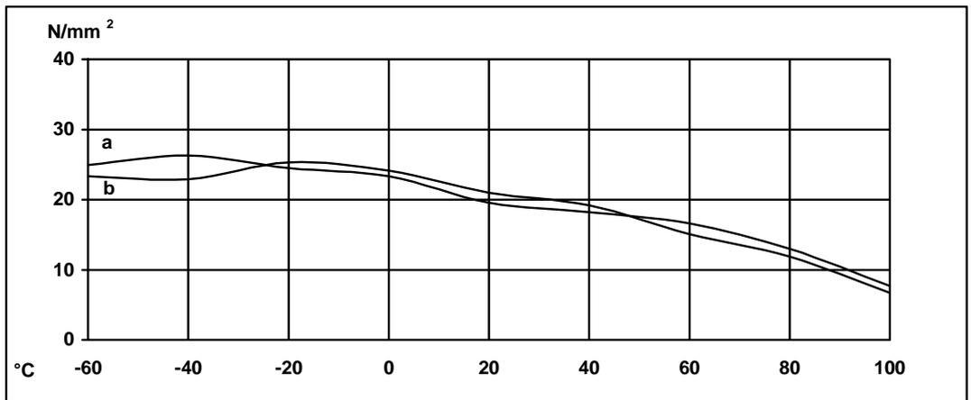
**Roller peel test (ISO 4578)**
